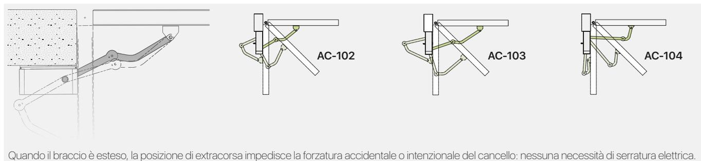
Quando il braccio è esteso, la posizione di extracorsa impedisce la forzatura accidentale o intenzionale del cancello: nessuna necessità di serratura elettrica.
